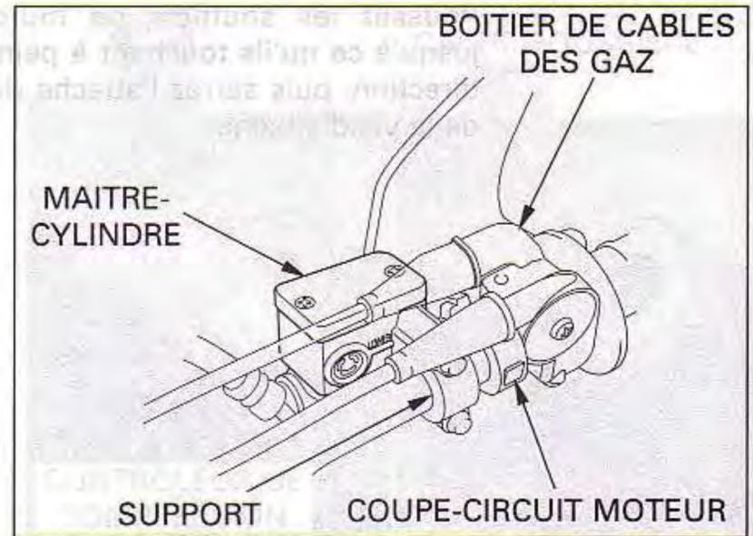
Déposez la vis et la protection de galet guide-câble des gaz.
