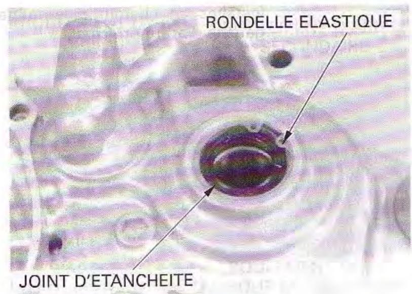
Déposez le roulement gauche d'arbre secondaire.
