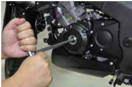
25. มาร์คตัว T ที่ส้อมแม่เหล็กตรงกับมาร์คที่ฝาครอบส้อมแม่เหล็กมาร์คขีดที่เฟืองเพลาราวล้นด้านไอดี (ขีดมาร์ค IN) และมาร์คขีดที่เฟืองเพลาราวล้นด้านไอเสีย (ขีดมาร์ค EX) จะต้องขนานกับขอบบนของฝาสูบ
