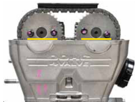
25. มาร์คตัว T ที่ส้อมแม่เหล็กตรงกับมาร์คที่ฝาครอบส้อมแม่เหล็กมาร์คขีดที่เฟืองเพลาราวล้นด้านไอดี (ขีดมาร์ค IN) และมาร์คขีดที่เฟืองเพลาราวล้นด้านไอเสีย (ขีดมาร์ค EX) จะต้องขนานกับขอบบนของฝาสูบ
