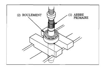
Installer un roulement nouveau sur l'arbre principal en utilisant une presse et des outils spéciaux.
