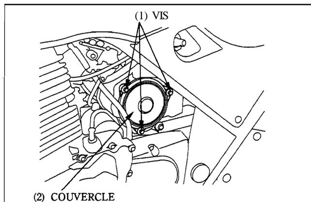
Déposer le filtre à air.
