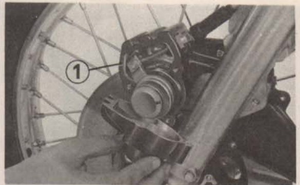
Fig. 4-28 (1) Joint d'étanchéité de couvercle de l'étrier
