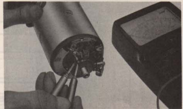
Fig. 3-107 Contrôle de l'état de l'enroulement d'induit
