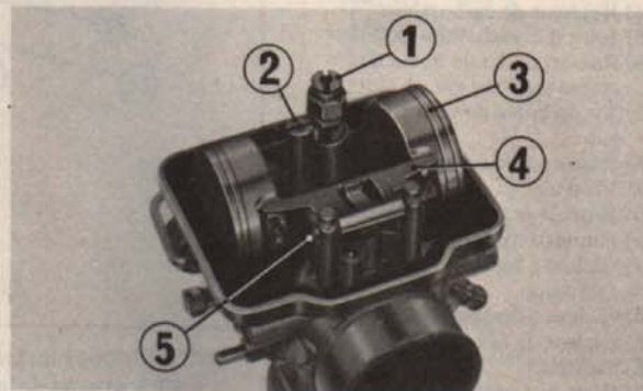
Fig. 3-75 (1) Gicleur principal (4) Bras de flotteur (2) Gicleur de ralenti (5) Pivot de bras de flotteur (3) Flotteur
