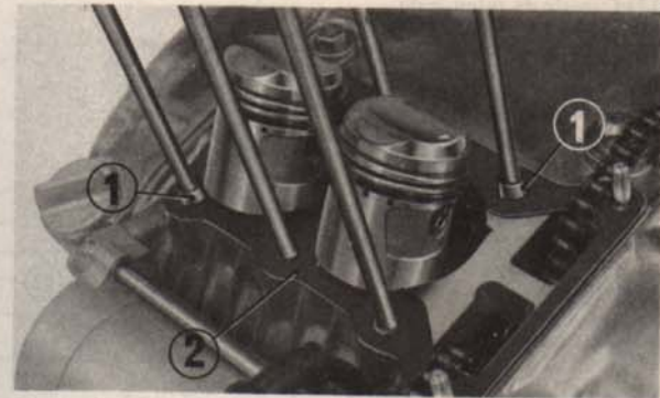
Fig. 3-26 (1) Goujon d'emboîtement (2) Joint d'étanchéité
