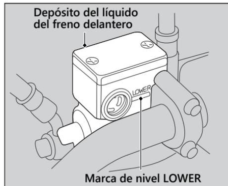
Si el nivel del líquido de frenos del depósito queda por debajo de la marca de nivel LOWER o el juego libre en la palanca del freno llega a ser excesivo, inspeccione el desgaste de las pastillas de freno. Si las pastillas de freno no están desgastadas, es probable que exista una fuga. Haga que inspeccionen la motocicleta en su concesionario.
