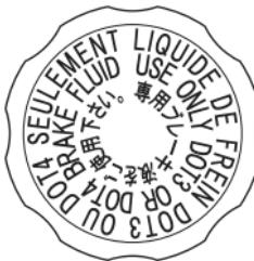
ЗАЛИВАТЬ ТОЛЬКО ТОРМОЗНУЮ ЖИДКОСТЬ
