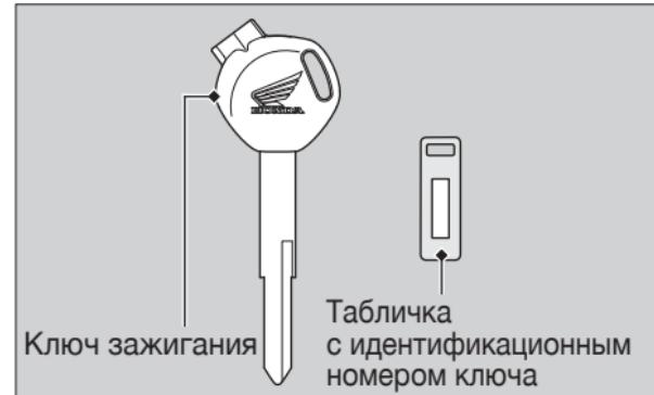
Металлический брелок на ключе зажигания может вызвать повреждения зоны вокруг замка зажигания.
