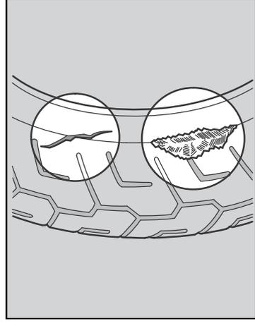
タイヤの全周に、亀裂や損傷、ひび割れおよび釘、石、その他の異物が刺さったり、かみ込んだりしていないかを点検します。道路の縁石などにタイヤ側面を接触させたとき、必ず大きな凹みや突起物を取り越したときは、必ず点検してください。
