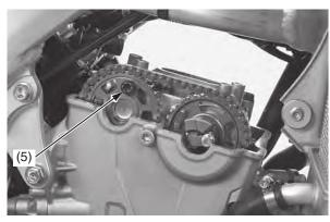
(5) cam sprocket bolt
