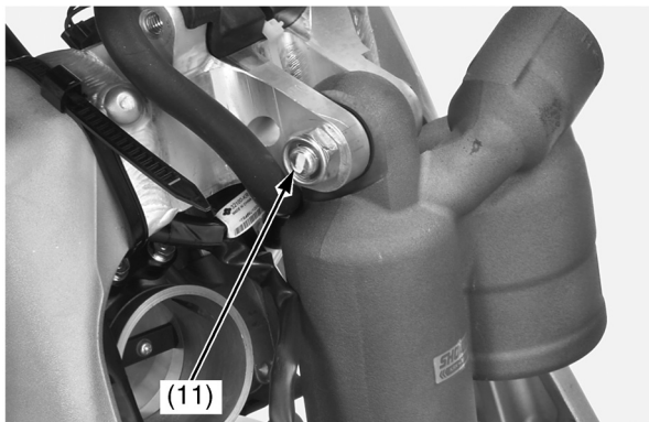
(11) верхняя гайка и болт заднего амортизатора
