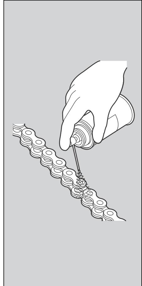
チェーンは、ゴムのシールを使用しているため、スチーム／高压洗浄、ワイヤーブラシ、ガソリンやベンゼンなどの揮発性溶剤、研磨材が入っている洗剤は使用しないでください。
