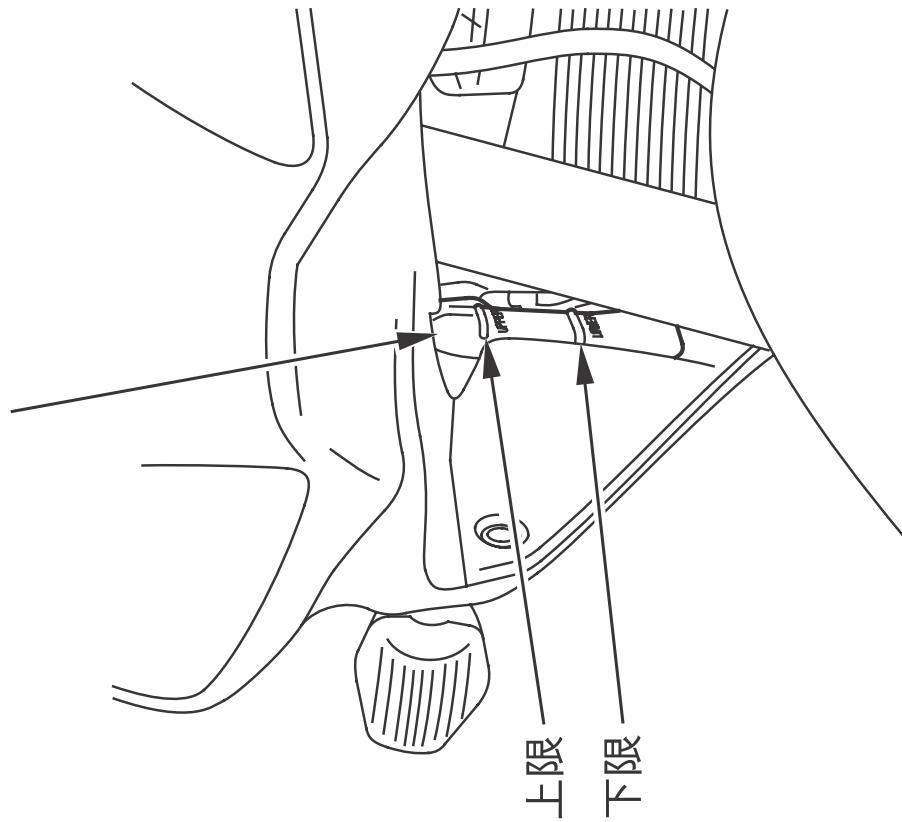
冷却水の減り具合が著しいときは、ラジエーター本体、キャップ、ホースなどからの水漏れが考えられます。
