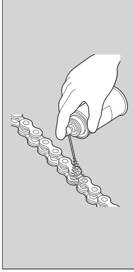
チェーンは、ゴムのシールを使用しているため、スチーム / 高圧洗浄、ワイヤーブラシ、ガソリンやベンゼンなどの揮発性溶剤、研磨材が入っている洗剤は使用しないでください。
