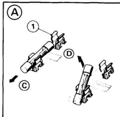
**ATENCION:** No alzaprimar las grapas abiertas para sacar un fusible; porque se podrían doblar y produciendo un contacto deficiente con el nuevo fusible. Un fusible flojo podría causar daños al sistema eléctrico e incluso podría provocar incendio.
