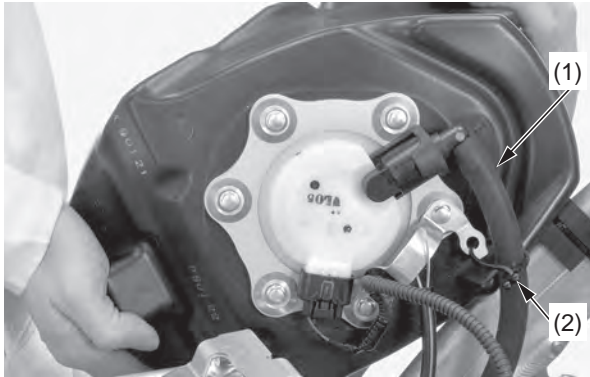
(1) flexible d'alimentation en carburant (2) bride
