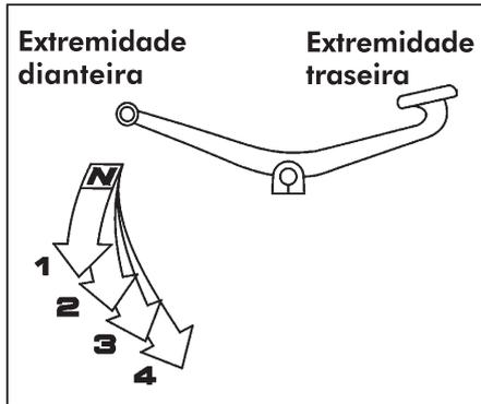
Pressione a extremidade traseira do pedal para reduzir as marchas. Acione os freios e o acelerador e mude de marcha de forma coordenada para obter uma desaceleração progressiva.
