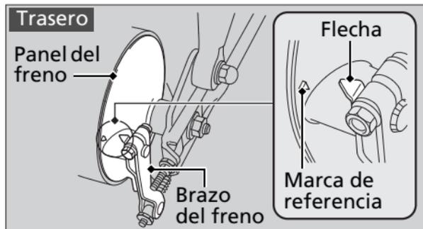
Cuando se acciona el freno, la flecha unida al brazo del freno se mueve hacia una marca de referencia en el panel del freno. Si la flecha se alinea con la marca de referencia al accionar el freno a fondo, es necesario reemplazar las zapatas de freno.
